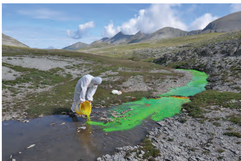
Traçage des pertes du lac de Lignin en 2014 qui a démontré la contribution de ce haut plateau à l'alimentation du Coulomp souterrain. The dye tracing of Lignin Lake sinkhole in 2014 that demonstrated the contribution of this high surface to the Coulomp underground river. Photograph Philippe Audra (2014)
