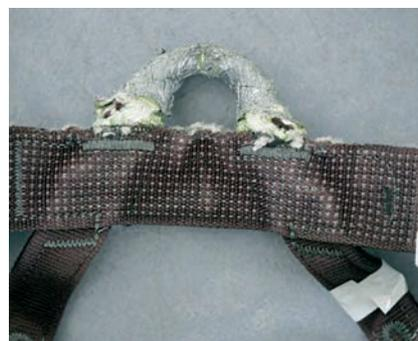
Usure et vieillissement d'un harnais de canyon.
