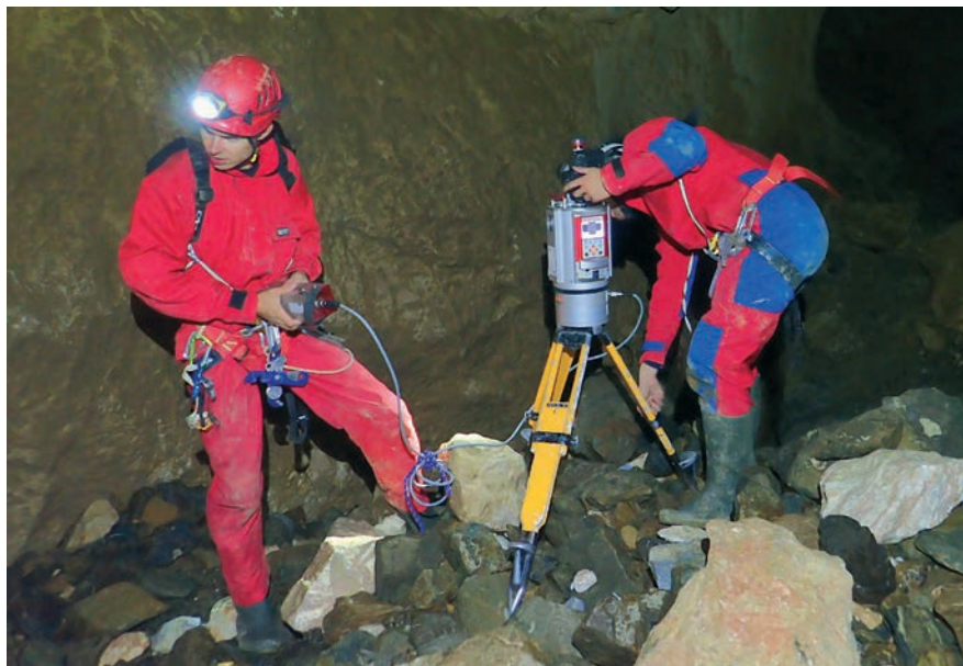
Photographie 4 : Michal et Jozef en cours d'acquisition avec le scanner laser Riegl VZ-1000. Cliché L. Danière.
