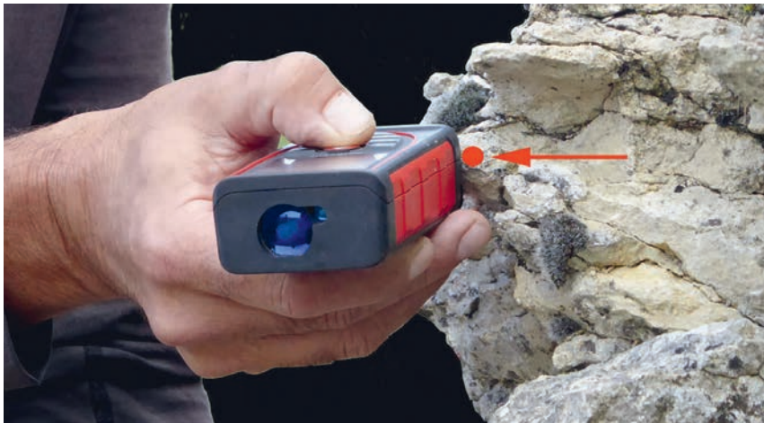
L'erreur de centrage est accentuée par le port du casque qui élargit la tête. Ce type d'erreur est fort diminué avec l'emploi du Distomat dont le rayon lumineux permet de viser sans œil.
