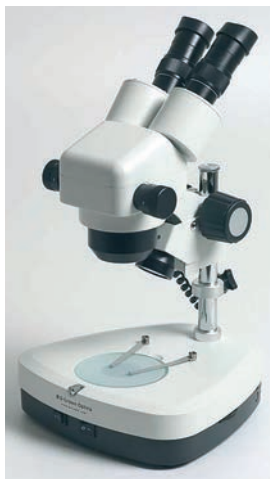
Photographie 10 : Binoculaire de qualité avec grossissement x 10 à x 40 progressif et éclairage transmis ou incident.
