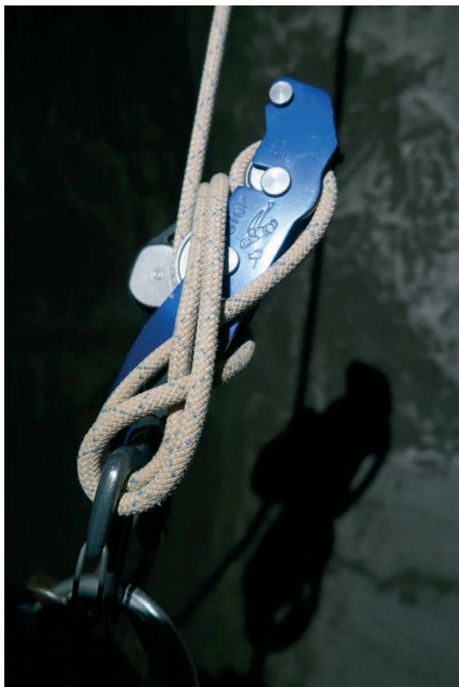
démontables, grâce au traditionnel axe vis-écrou. Mais c'est maintenant du 13 mm à la place du 14. Surtout, le descendeur « Simple » est annoncé utilisable avec des cordes de 8,5 à 11 mm de diamètre.
