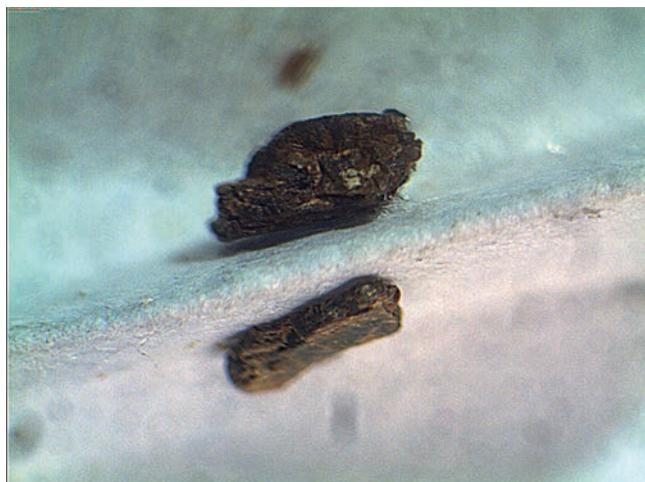
Comparaison entre un mica chauffé (en haut) et un mica non chauffé (en bas) montrant leur différence d'épaisseur.
