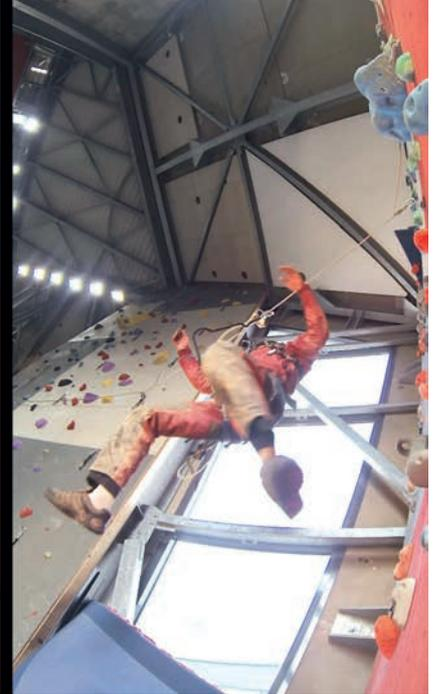
**Dans l'un des cas, le bloqueur de poing s'est ouvert complètement et a été éjecté de la corde :** le corps du bloqueur s'est déformé, la gorge entourant la corde s'est évasée, la gâchette a été tordue, le rivet la fixant s'est également déformé. Le spéléologue s'est retrouvé désolidarisé de la corde et n'a été retenu que par la contre-assurance de sécurité installée pour le test.
