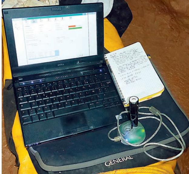
Relève des données sur le terrain, au siphon 1 de la grotte du Régaie de Néoules (var). L'ordinateur permet de récupérer les données de la sonde CTD posée sur le socle. La sonde, paramétrée pour enregistrer les données au pas de temps de quinze minutes, peut enregistrer de manière autonome les données de conductivité électrique, température et pression pendant plusieurs mois. Cliché B. Arfib, 15/08/16.
