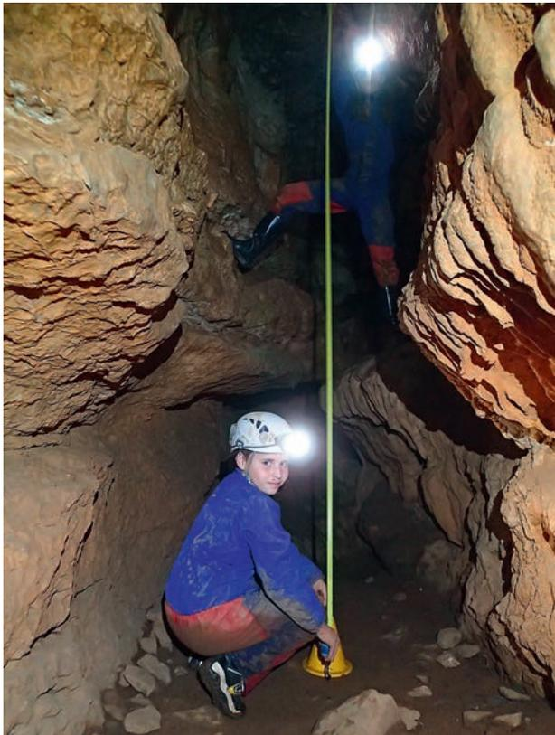
Dans la grotte des Rampins, les élèves de collège s'initient à la topographie spéléologique au cours d'une sortie dans le cadre du dispositif « Eaux souterraines ». Ils observent, mesurent les longueurs, directions et pentes, et notent sur le terrain. Ils calculeront et dessineront en classe. Cliché F. Mourau, 13/12/16.
