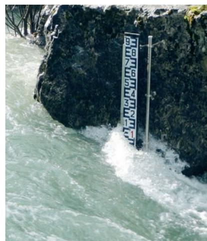
Figure 3: La station hydrométrique lors d'une crue de fonte, le débit à cet instant frôlait les 20 m<sup>3</sup>/s (ACEC 2016).
