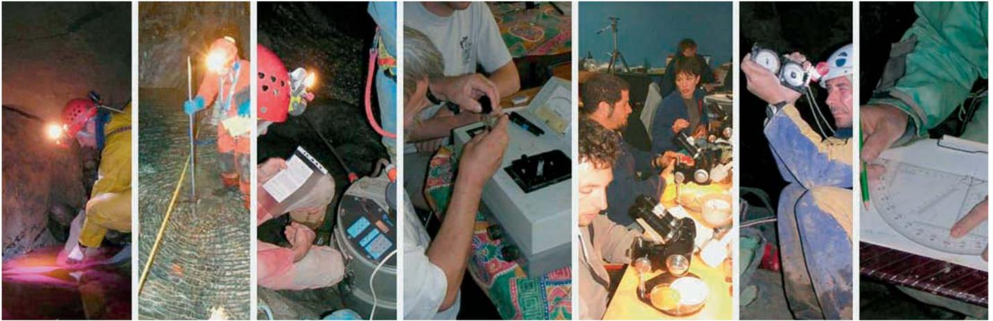
Figure 5: Injection de colorant, jaugeages de rivières souterraines, mise en place de préleveurs automatiques, utilisation de spectrocromimètre, identification à la binoculaire d'espèces récoltées, topographie, cartographie... Photos : stage « Equipier scientifique » / module 2 du cursus moniteur FFS.
