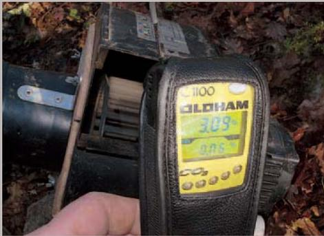
Mesure du taux de CO<sub>2</sub> à la sortie de la turbine d'aspiration. Igue de Penayrols (82). Clichés Michel Soulier.
