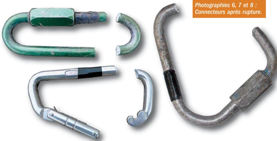
Photographies 6, 7 et 8 : Connecteurs après rupture.
