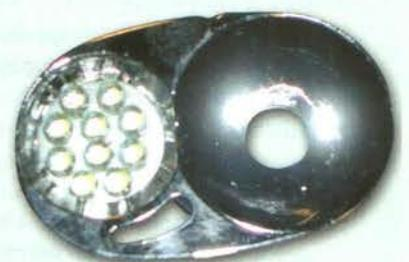
10 leds montées dans le déflecteur de la Duo Petzl. ▼
