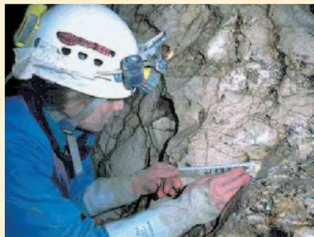
Mesure des longueurs des coups de gouges à la goule de Foussoubie (Ardèche) pour déterminer les débits de pointe de crue. Stage "Équipier scientifique" 2000. Photographie S. Jaillet.
