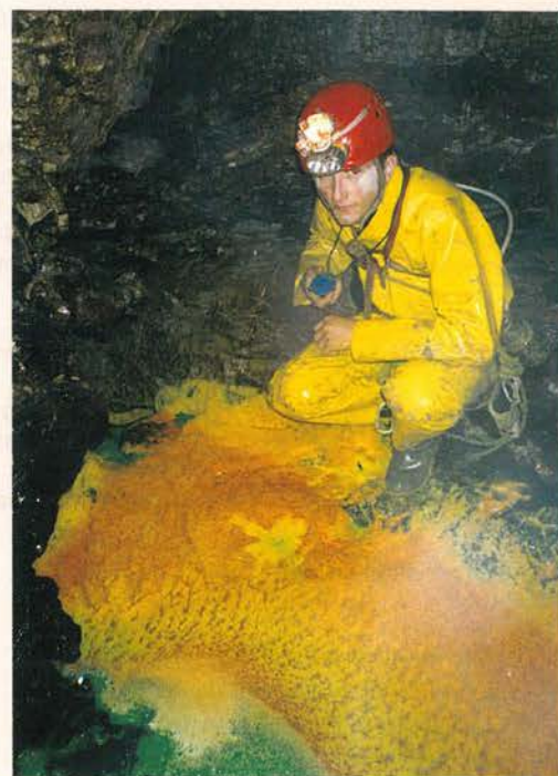
Massif des Bauges. Pic de la Sauge. Perte de l'Antre Nant. 1997. Expérience de coloration à -160 pour vérifier la relation du ruisseau souterrain avec la source captée de Combe Noire. Relation confirmée : périmètre de protection étendu jusqu'à inclure le gouffre et interdiction d'accès dans ce dernier (périmètres en projet, nous allons négocier là aussi pour qu'ils soient révisés).
