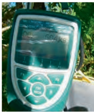
Deux dynamomètres installés en série, permettaient l'enregistrement constant et la lecture directe des données de tension au point bas de la tyrolienne.
