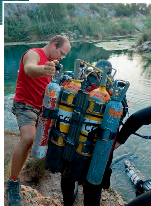
Mise à l'eau avec le dorsal qui alimentera les recycleurs, un Bi 12 de Tx 7/80 avec ses deux 3L d'air (la grise) et d'Oxy (la rouge) sur les côtés. Cliché Isabelle Perpoli.
