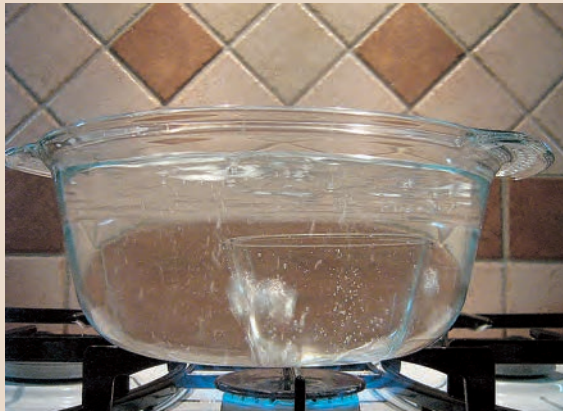
Figure 7 : aux alentours de la zone de chauffe, l'eau arrive à 100°C ; les premières bulles de vapeur (plus grosses que les bulles de gaz) se forment, mais elles se condensent en traversant la couche superficielle d'eau qui est à moins de 100°C et n'atteignent pas la surface qui ne présente pratiquement aucune agitation ; en revanche, dans le fond de la casserole, ça s'agite tellement que la coupelle s'est renversée. Cliché de l'auteur.
