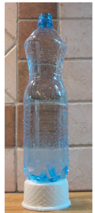
Figure 10 : dès que la pression baisse, une partie de l'acide carbonique se décompose et du CO 2 reprend sa forme gazeuse.
