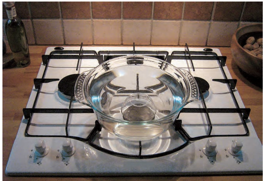
Figure 4 : le dispositif expérimental destiné à mettre en évidence le dégazage provoqué par l'élévation de température ; l'huile d'olive et les noix ne sont pas des ingrédients indispensables à l'expérience. Cliché de l'auteur.
