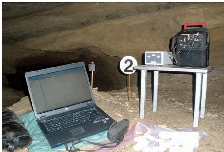
*Des mesures de température et d'humidité ont été effectuées sur plusieurs jours, en utilisant des sondes radioguidées.*
