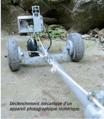
Déclenchement mécanique d'un appareil photographique numérique.
