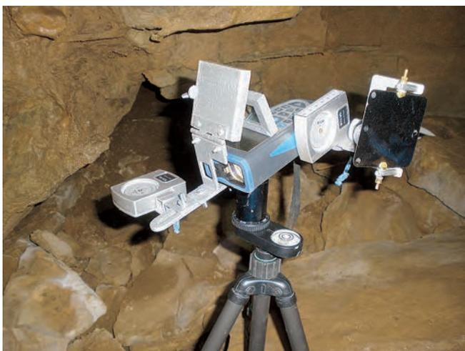
Instrument topographique équipé pour des passages de faible section.
