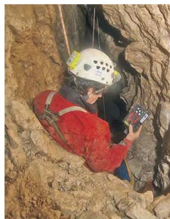
Mesure de gaz en cours de progression. Les gaz à surveiller sont l'oxygène (O<sub>2</sub>), le monoxyde de carbone (CO) et le dioxyde de carbone (CO<sub>2</sub>).
