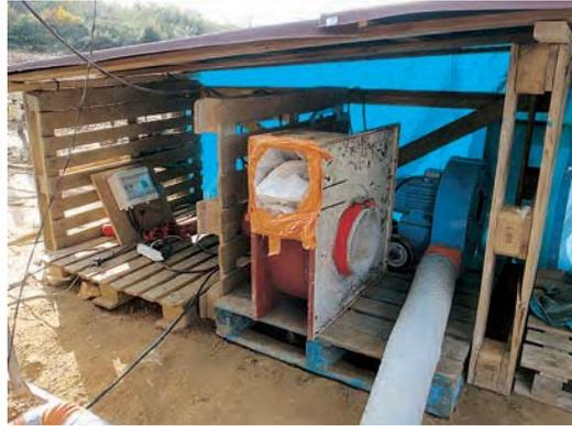
Les turbines de soufflage. L'une d'elle fonctionne en permanence. Elle pulse de l'air extérieur vers le fond de trou par une gaine géolène de 160 mm de diamètre.
