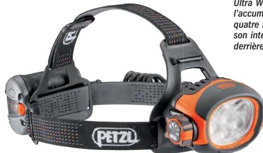
**Ultra Wide.** On distingue à gauche l'accumulateur avec le bargraph à quatre niveaux, à droite le boîtier lampe avec son interrupteur verrouillable à 4 positions, derrière le bandeau le fil torsadé
