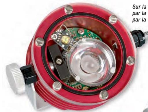
Sur la Scurion 900, l'éclairage lointain est assuré par la led jaune (en haut en gauche) et celui large par la led basse, avec un large diffuseur.
