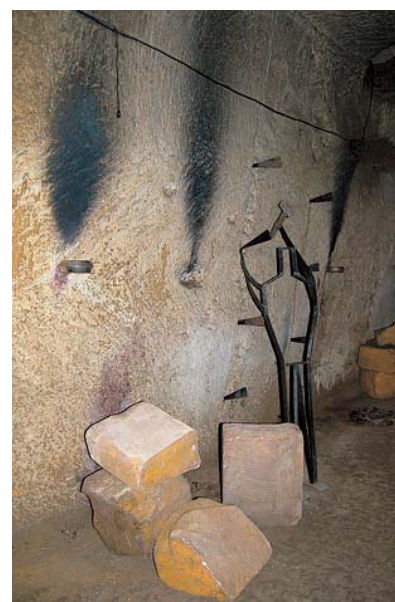
Extraction du tuf volcanique comme matériau de construction. Clichés Nathalie Duverlie.
