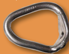
Photographie 7 : anneau Annelox avant et après test.
