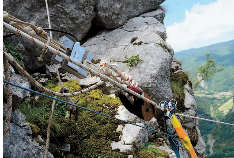
Instrumentation de mesure : Au premier plan, un dynamomètre prêt par la société Algosys permet une mesure continue de la tension exercée. Au second plan, se trouve la poulie test dotée d'un compte-tours ainsi que de capteurs de mesures de température. Ces appareillages sont connectés à un boîtier d'enregistrement des données. Cliché Bernard Tourte.
