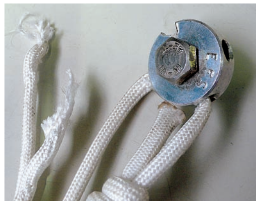
Photographie 4 : AS après rupture.
