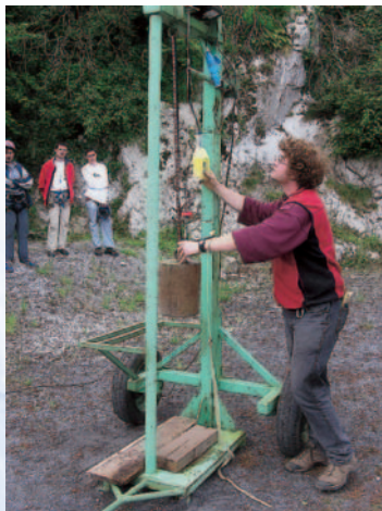
Essais de corde avec la « Testotruc » par Mathieu Rasse.
