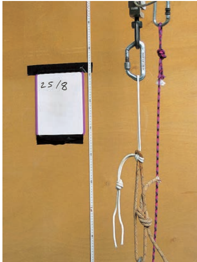
Photographie 6 : Test en traction lente du nœud de tisserand simple, brin double, butée double pour relier la corde.
