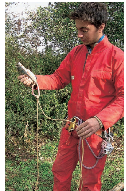
Photographie 3 : Usage de la Dyneema. Pédale double : reliée par une tête d'alouette au mousqueton de poignée, elle est facile à désolidariser, elle tient sans problème dans la poche, et on dispose d'une cordelette sans nœud de plus d'un mètre.
