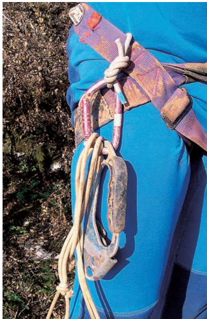
Photographie 2 : Usage de la Dyneema. Un anneau de quelques centimètres de diamètre bien fermé peut remplacer avantageusement les fines sangles dites « porte-matériel » cousues sur le harnais.
